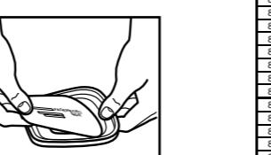
2. Appuyer le dispositif de retenue de filtre 501 (07054) contre la cartouche. Il devrait s'enclencher fermement à la cartouche. Le filtre 5P71 (07194) doit recouvrir complètement la cartouche.
