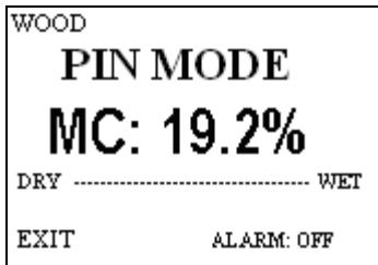
3. Empuje las patillas de contacto en el material que va a medir. También se puede usar cualquier electrodo Delmhorst en el modo MADERA conectándolo al conector que está junto a las patillas de contacto.
