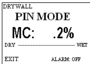
3. Empuje las patillas de contacto en el material que va a medir. También se puede usar cualquier electrodo Delmhorst en el modo TABLERO DE YESO conectándolo al conector que está junto a las patillas de contacto.
